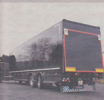
LE MINI-SEMI ECOROAD D'ANCY autorise la charge utile pour un PTRA (poids total roulant autorisé) jusqu'à 9 t avec un permis B+E.
