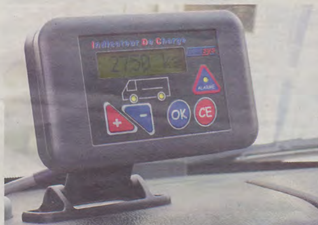
Équiper son véhicule d'un système de pesée intégré permet de contrôler depuis l'habitacle la charge utile et d'être averti de la surcharge.
