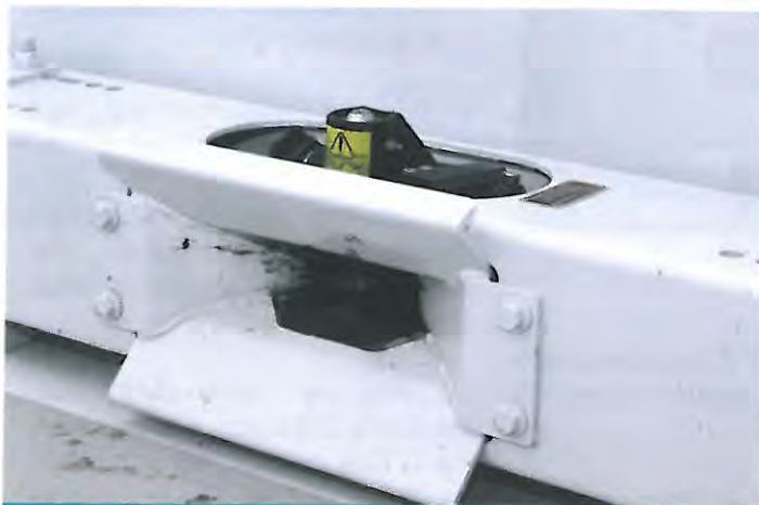
Le système d'attelage est particulièrement sûr. Pour finaliser la manœuvre, le centrage est finalisé par les petites roulettes placées dans les angles arrière.
