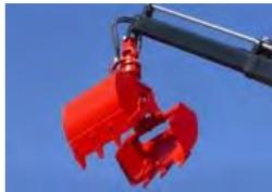
Grue avec treuil / rotator / benne preneuse
